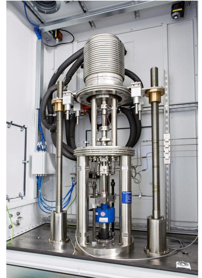
Einfluss von Druckwasserstoff auf des Verformungsverhalten des Schmiedestahls 1.5132 unter 50 bar Druckwasserstoff.
